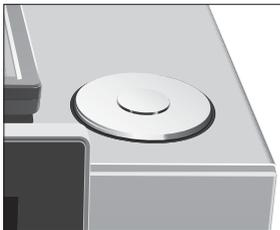
Comando tramite **Rotary Switch**: utilizzare in aggiunta il Rotary Switch. Ruotandolo viene visualizzata la visualizzazione circolare dei prodotti. Consente inoltre di navigare attraverso le opzioni di programma nella modalità di programmazione e di modificare diverse impostazioni.
