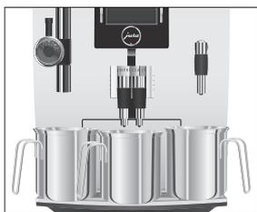
▶ Collocare un recipiente sotto il raccordo dell'ugello per cappuccino e uno sotto l'ugello dell'acqua calda.
