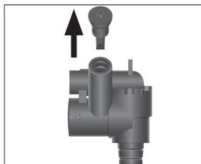
Если используется функция приготовления молока, для обеспечения безупречного функционирования комбинированного дозатора, а также из соображений гигиены, дозатор обязательно **ежедневно** разбирать и промывать.
